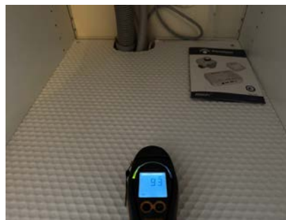
Ingen forhøyede fuktverdier ble registrert i kjøkkenbenken.
