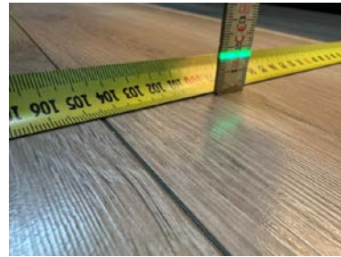
Måling av etasjeskille på kjøkkenet.
